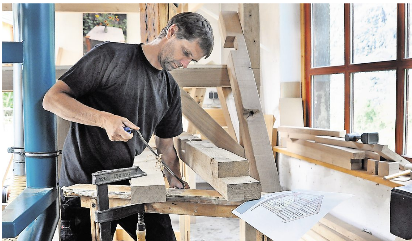
Mit dem Zieheisen verpasst Tischlermeister Till Eppler den glatten Eichenholzbalken ein markantes Aussehen. Hinter ihm ist ein Teil der neuen Hütte der Eule Rosalie zu sehen. Die Zeichnung unten rechts zeigt, wie diese aussehen soll. Meister Epplers Tochter Jannika nutzt den dazugehörigen Sattel als Lieblingsplatz.
